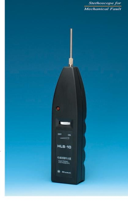
**能** 检测机械内部振动情况。 通过高灵敏压电式传感器, 拾取微弱的音频信号并进行放大, 从而分辨出正常 / 异常的信号及其所在部位。 通用性强, 适用于任何旋转机械的故障诊断。
