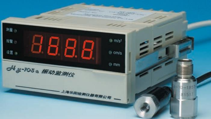
**振动** 监测仪是一种固定安装的单通道振动在线监测仪器，可测量机械设备的振动加速度、速度或位移，并具有二级超限报警功能，主要用于对工矿企业中关键设备的状态监测。
